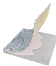
Klejenie wykładziny z betonem
